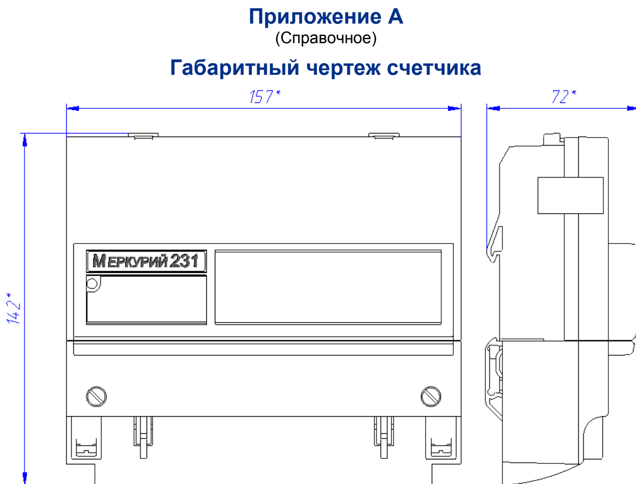
Рисунок А.1 – Габаритный чертеж счетчика без индекса «ш» в коде
